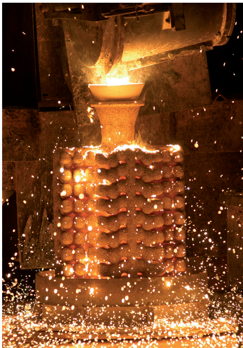
Le métal en fusion coule dans le moule, mais la répartition n'est pas toujours homogène.
